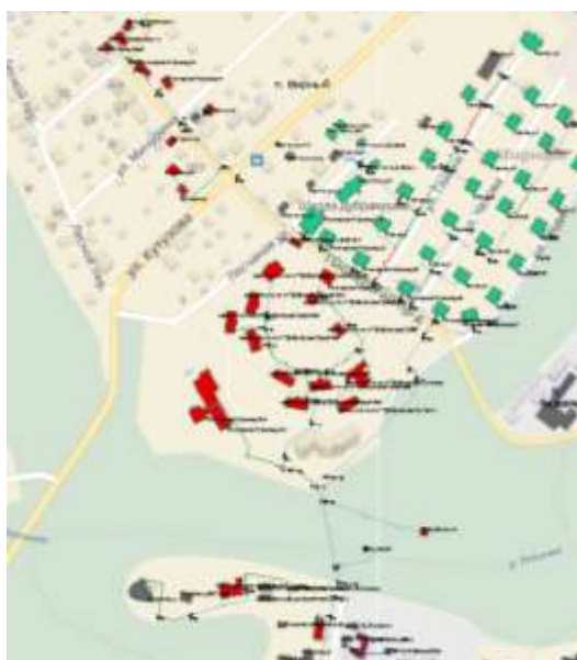
Рисунок 23 – Потребители в п. Мирный, давление в обратных трубопроводах систем теплоснабжения которых превышает 6 \text{ кгс/см}^2
